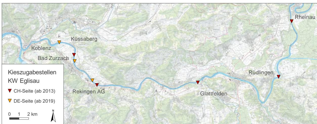
**Abbildung 44:** Standorte, an denen die Kraftwerk Eglisau-Glattfelden AG als Auflage zur Baubewilligung für den Ausbau des Kraftwerks Eglisau verpflichtet wurde, periodisch Kies in den Hoahrhein einzubringen.
